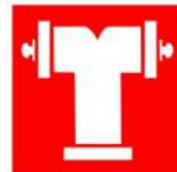
消防水泵接合器
